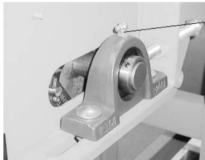
ONE GREASE FITTING ON THE BEARING BLOCK ON EITHER SIDE OF THE UNIT.
